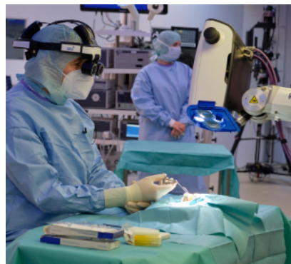
Prof. Löwenheim steuert mittels eines Head-Mounted Displays einen Roboterarm mit Kamerakopf. Foto: Michael Latz/BioRegio STERN
